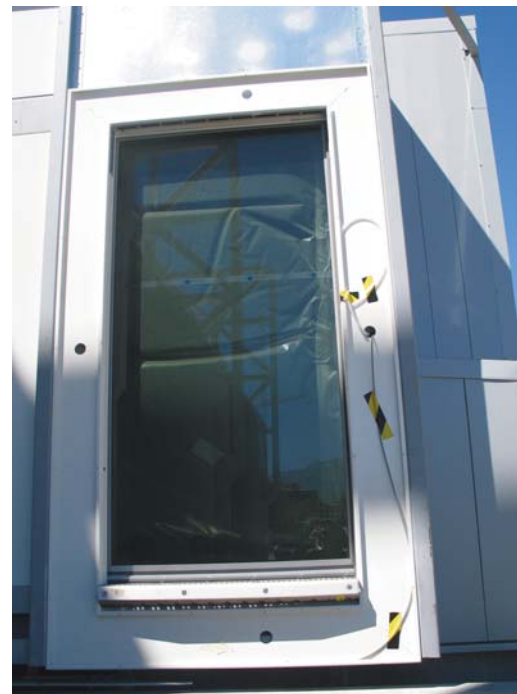
Un joint gonflable assurera l'étanchéité avec la gare et un flux d'air purgera l'espace entre les deux portes.
