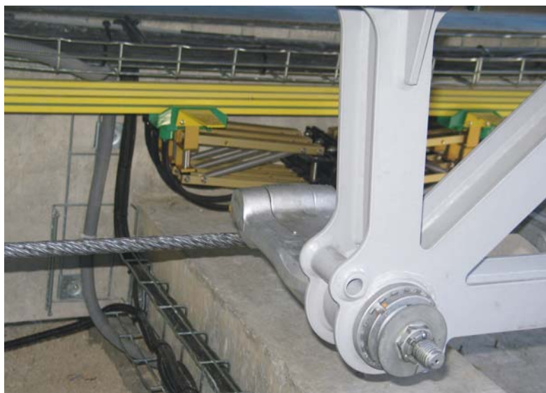
La cabine est alimentée en électricité à la manière des caténaires des trains : le courant passe par trois petits rails jaunes et est récupéré via des frotteurs sous le système.
